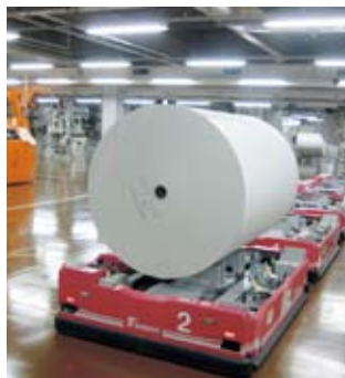
新聞用紙運搬ロボット（AGV）
