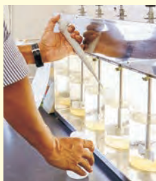
▲原水の汚れを効率的にとるため薬品注入設定を決める検査。
