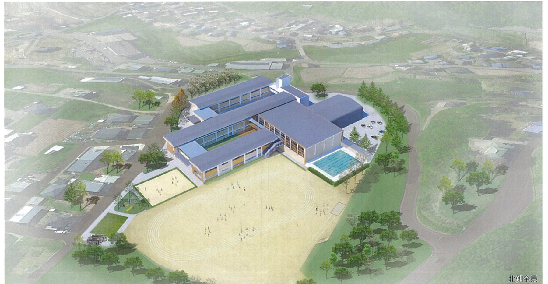
既存校舎と新校舎・新屋内運動場が中庭や渡り廊下を介して合理的につながる平面計画 管理ゾーン(職員室、会議室など)、小学生/中学生ゾーン(普通教室、特別教室など)、共用・運動ゾーン(体育館、プール)を明快に配置した平面計画です。
