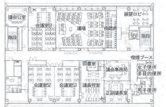
▲ 5階 (床面積 1,208.92㎡、天井高さ* 2.7m) * 議場部分は 5.8m
