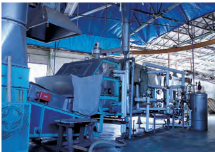
左：普通酒の仕込みに使用している大型の連続蒸米機 右：酒造りの始まりを待つ麹室
