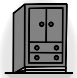
ストッパー式 家具の最下部にくさび状に挟み込み、家具を壁側に傾斜させるタイプ
